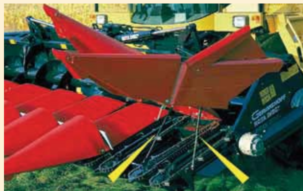
提高保护：工业气弹簧保护重盖子。
