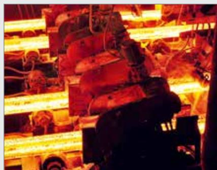
钢铁冶炼：减少当钢卷制造过程中热线圈下降时产品的冲击和振动
