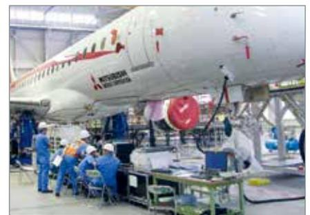
飞机测试：Fabreeka-SSS 软支撑系统用于浮起飞机进行地面振动测试（GVT）
