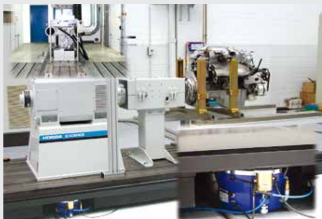
PAL 空气弹簧用于电机测试平台
