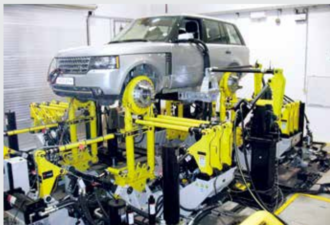
底盘测功机地基础隔振
