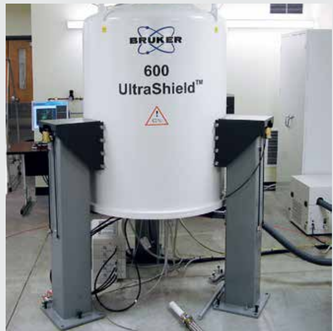
PAL18 万向节空气弹簧用于 600 MHz NMR
