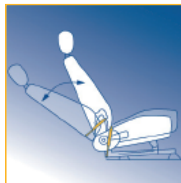
右面:带独立活塞的刚性锁止气弹簧 BLOC-O-LIFT®
