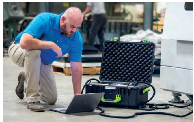
现场振动测量
