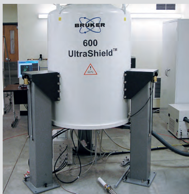
PAL18 万向节空气弹簧用于 600 MHz NMR
