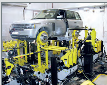
汽车测试: 用于道路模拟测试, 发动机测试台架, 测功机, 及其他测试设备的低频隔振系统
