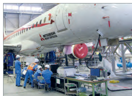
飞机测试：Fabreeka-SSS 软支撑系统用于浮起飞机进行地面振动测试（GVT）
